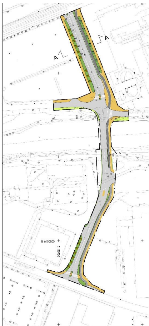
Figur 3.2 Ungefärlig utbredning av föreslagen stabilitetsförbättrande åtgärd i anslutning till den planerade brons stöd på södra sidan av Säveån enligt Sweco Civil AB (2019).
